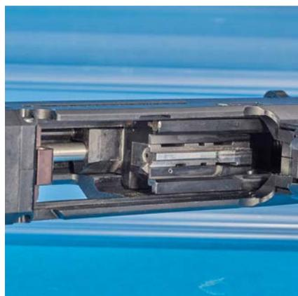
Im Polymer-Gehäuse arbeitet der Masseverschluss auf einer Führungsstange.
