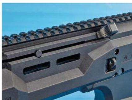
Der Spannhebel läuft im Schuss nicht mit dem Verschluss zurück. In seiner hintersten Position kann man ihn nach oben schwenken und so den Verschluss offen arretieren.
